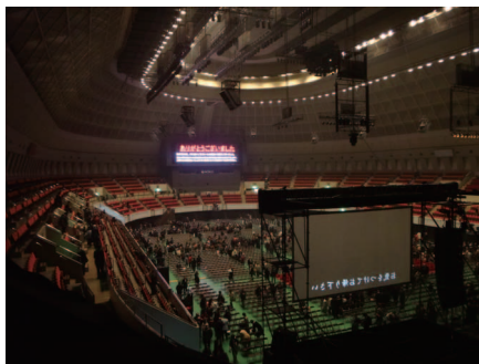
ワールド記念ホールに設置された大型LEDビジョン。主にホール内で開催されるバスケットボールやバレーボール、フットサルやテニス等のスポーツ競技大会で、得点板、時刻表示等として使用している。サイズは、W14,336mm×H4,096mm(587inch)。
